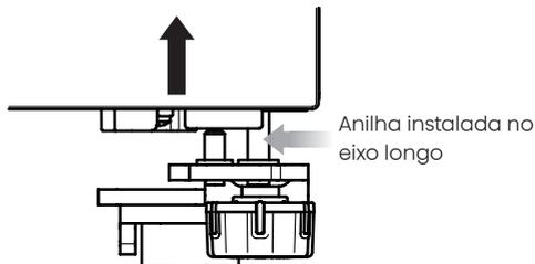
4. Especificação da junta de tipo "C": Disponível em 1,0 mm e 1,5 mm com a espessura indicada na anilha.
