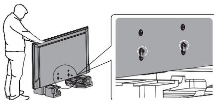
6. Segure a Parte a1 e a Parte B montadas para os dois parafusos M4 × 8 que fixou à TV, fixe então a parte montada à TV com quatro parafusos M5 × 16. Pode ajustar a altura do suporte base para H1 ou H2. Para H1, fixe os parafusos nos quatro orifícios 1. Para H2, fixe os parafusos nos quatro orifícios 2.
