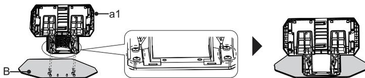
5. Fixe os dois parafusos M4 × 8 aos orifícios dos parafusos na traseira da TV, conforme ilustrado.
