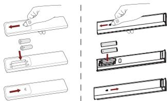
1. Deslize a tampa traseira para abrir o compartimento das baterias do controlo remoto.
