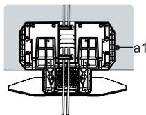
8. Coloque a Parte a2 na Parte a1 e monte juntas. Bata nos quatro lados da Parte a2.
