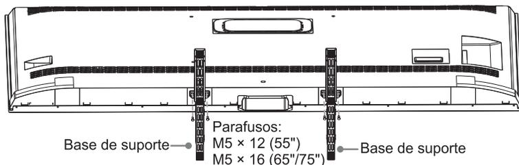
4. São necessárias duas pessoas para endireitar a TV nos suportes e colocar numa superfície plana.
