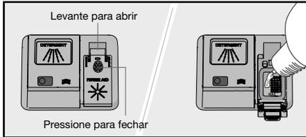
1. Abra a tampa do compartimento do auxiliar de enxaguamento.
