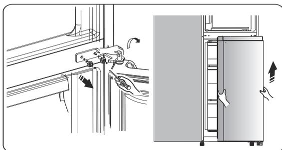
9. Coloque a porta inferior em uma superfície lisa com o painel para cima. Solte o parafuso ③ e retire a parte ② e a parte ①, instale o retentor da porta de substituição à esquerda ④ (fornecido no saco de plástico) e a peça ② (bloco de bloqueio) para o lado esquerdo com o parafuso ③. Mantenha a parte ① com o aparelho para referência futura.
