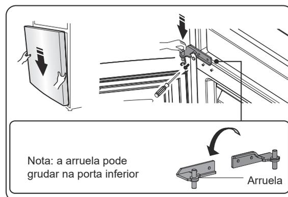
15. Mova a porta superior para uma posição apropriada e, depois, fixe a parte ② com parafusos ①. Antes de fixar a parte ②, passe o conector ③ pela dobradiça ② consultando o passo 3. (Por favor segure a porta superior manualmente ao instalar)
