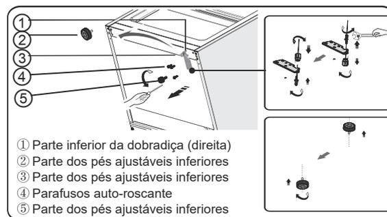
12. Remova a peça ③ do pino da dobradiça inferior, solte o pino da dobradiça inferior, mude para o local do orifício invertido e, em seguida, aperte na posição, depois instale a peça ③ no pino da dobradiça inferior.
