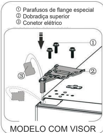
16. Conete o conector elétrico ① como mostrado na imagem, então fixe a porta ② com parafusos ③ consultando o passo 2.
