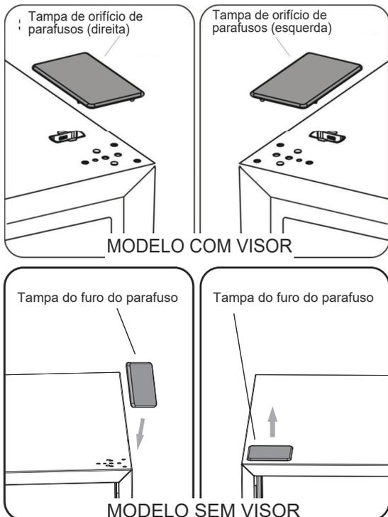
6. No caso de um frigorífico com visor na porta, remova a parte ① do lado esquerdo superior da tampa superior e retire a parte ②. Depois, remova a parte ③ e coloque a parte ④ no lado direito superior da tampa superior. Consulte a operação acima, instale a parte ③ e a parte ④ no lado esquerdo superior da tampa superior. Instale a parte ① do lado direito superior da tampa superior. No caso de um frigorífico sem visor na porta, salte este passo.
