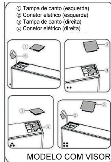
7. Desaperte o parafuso ③ e tire a parte ② e parte ①. Instale a tampa esquerda de substituição ④ fornecida (em saco de plástico) e a parte ② (batente) no lado esquerdo do parafuso ③. Mantenha a parte ① com o aparelho para referência futura.
