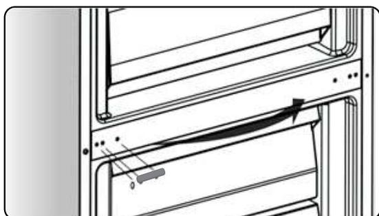
11. Incline o refrigerífico para trás e remova a parte ②.
