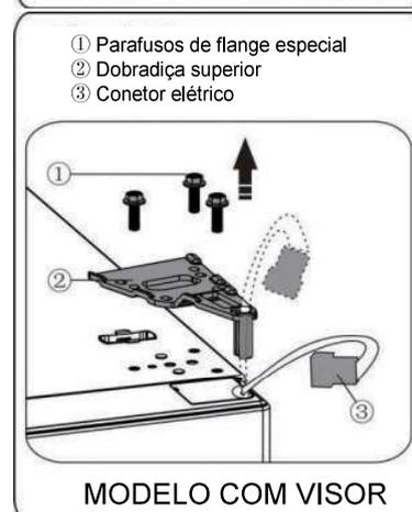
4. Remova a porta superior da articulação do meio subindo cuidadosamente a porta para cima. Em seguida, coloque a porta superior numa superfície lisa com a tampa superior para cima.
