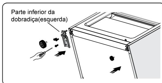
14. Encaixe a porta inferior para o pino de dobradiça inferior e mantenha-a em posição. Gire a dobradiça do meio em 180°, mude a arruela do eixo para o lado inferior, ajuste a dobradiça do meio para a posição apropriada e, em seguida, instale-o com a porta inferior no local seguro.
