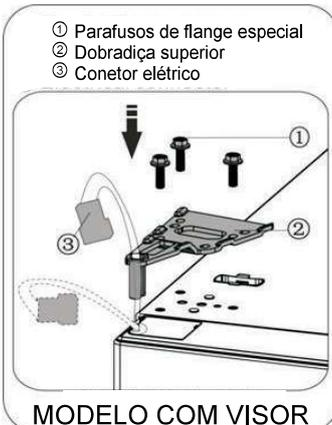
16. Conecte o conector elétrico ① como mostrado na imagem, então fixe a porta ② com parafusos ③ consultando o passo 2.
