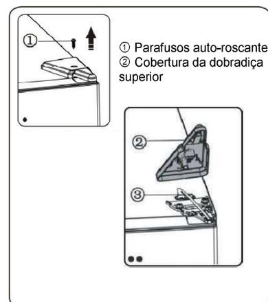
3. Remova os parafusos ① e a dobradiça ②. No caso de um refrigerador com visor na porta, é necessário passar o conector ③ pelo orifício da dobradiça ② (Por favor, segure a porta superior com a mão durante a instalação).
