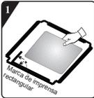
Antes da instalação da placa inferior de redução de ruído, cole o algodão de absorção de som na placa, alinhando-o com a marca de imprensa retangular (Este passo será omitida para alguns modelos que não possuem algodão de absorção de som).
