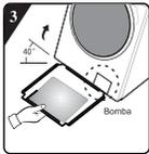
Inclinar a máquina num ângulo de 40 ° e deixar o lado com ângulo reto com entalhe para frente da máquina de lavar, como mostrado na figura. Inserir o lado oblíquo entre dois parafusos de pé na parte traseira da máquina de lavar. Em seguida, instalar a placa de fundo e garantir que está em contacto com fundo da máquina de lavar roupa.
