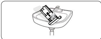
2. Abrir as tampas de ambos os compartimentos, adicionar água e agitar para soltar/remover os resíduos de sabão. Repita até ficar limpo.
