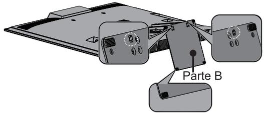
6. Fixe então a Parte B com 6 parafusos (M5 × 16).
