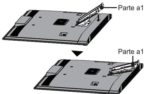
4. Segure a Parte a1 com 4 parafusos (M5 × 12) à parte traseira da TV.
