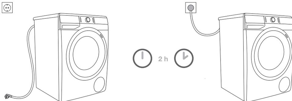
**⚠ Antes de ligar a máquina de lavar roupa à rede elétrica, aguarde pelo menos duas horas para atingir a temperatura ambiente.**
