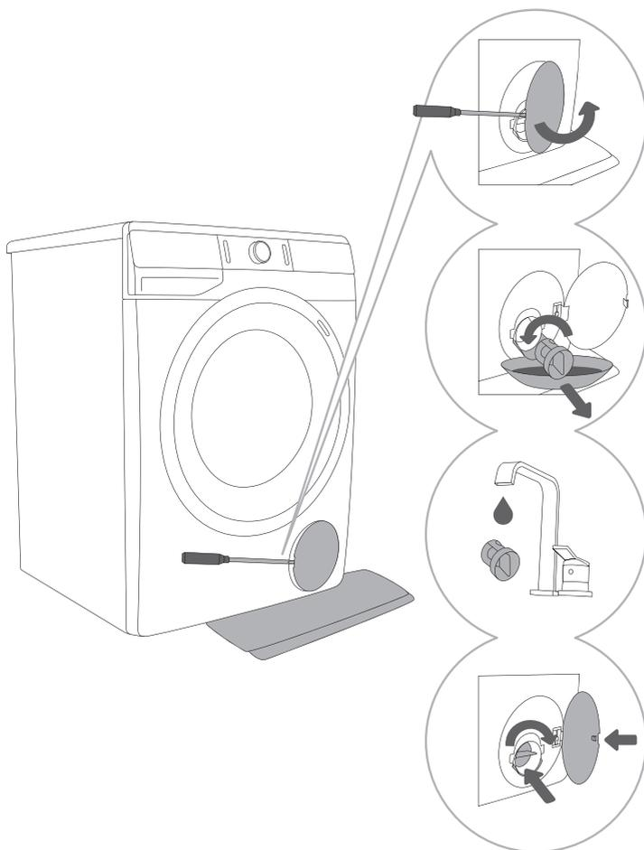
**1** Abra a porta do filtro da bomba com uma ferramenta apropriada (chave-de-fendas plana ou similar).
