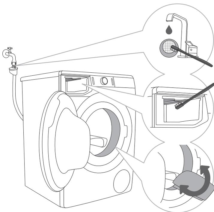
**1** Limpe frequentemente o filtro de malha com água da torneira.
