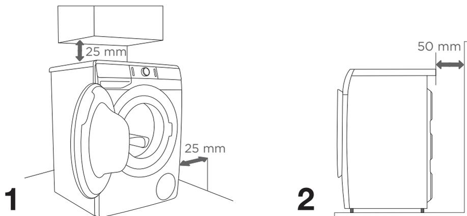
⚠ A máquina de lavar roupa não deve tocar na parede nem nos móveis adjacentes. Para um melhor funcionamento, recomendamos de respeitar as distâncias entre as paredes e a máquina, tais como indicado na figura.
