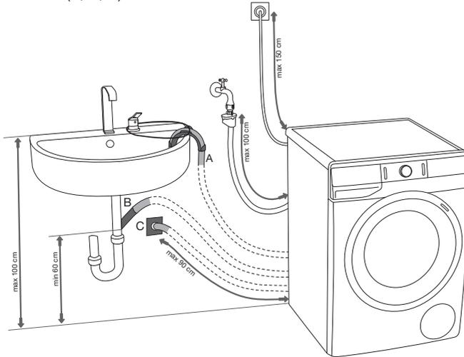
**A** Pode colocar a extremidade do tubo flexível de drenagem na extremidade de uma pia, de um lavabo. Fixe o tubo com um fio, depois passe no ilhó do cotovelo para evitar que este caia no chão.
