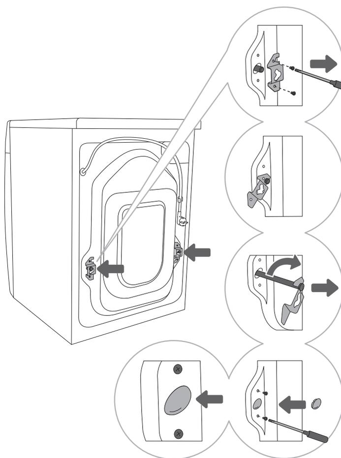
**1** Afaste os tubos e retire os parafusos na parte traseira da máquina.
